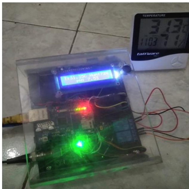
Gambar 5 Pengujian Sensor DHT22
