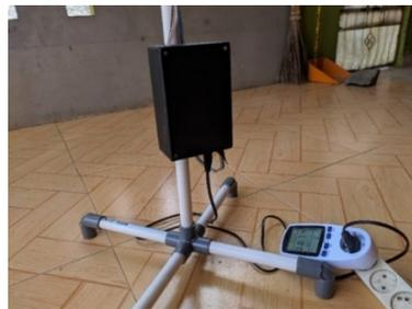
Gambar 11 Pengukuran dengan Watt Meter
