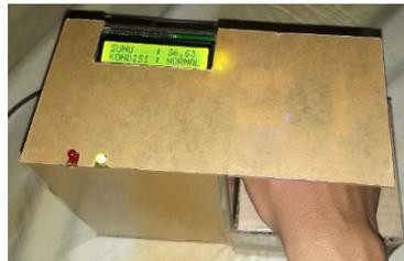
Gambar 8 Hasil Suhu Tubuh dan Kondisi Badan pada Layar LCD 16x2
