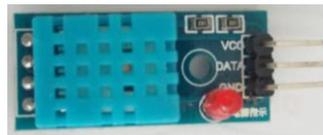
Gambar 2 Sensor DHT11
