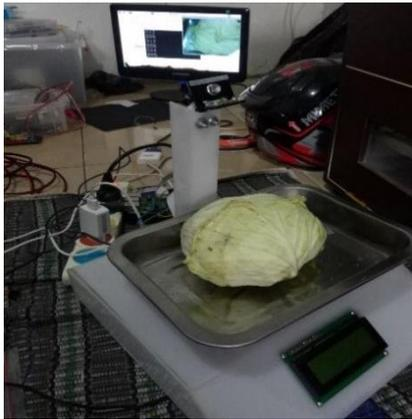
**Gambar 8** Pengujian Pengambilan Citra pada Timbangan
