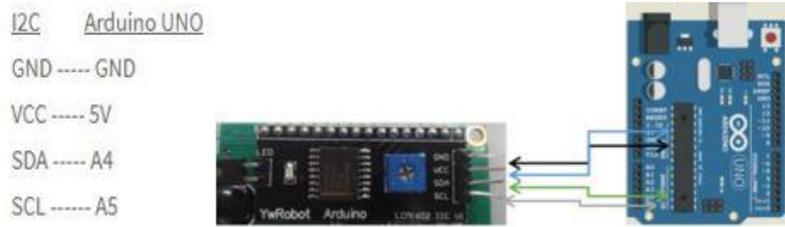
**Gambar 13** Konfigurasi Pin I2C Dan Arduino
