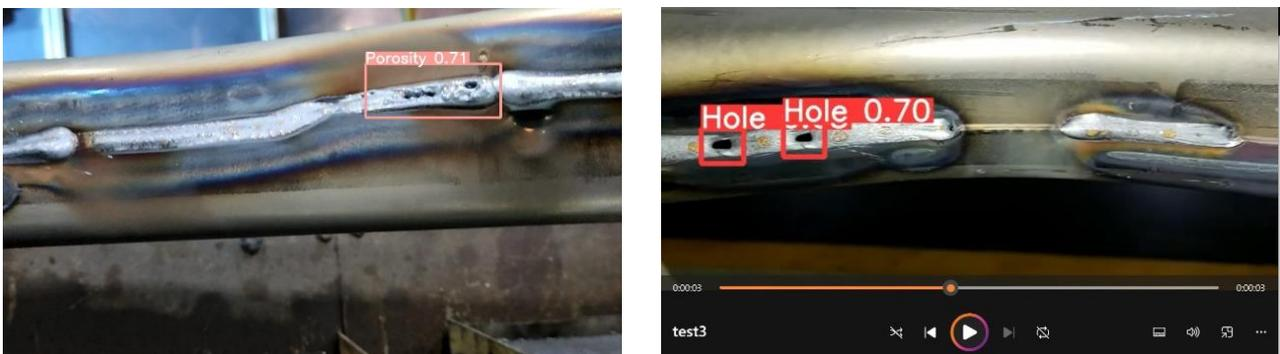
Gambar 3.8 Citra hasil Test model dengan data testing
