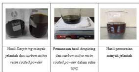
Gambar 2. Proses pemurnian minyak jelantah
