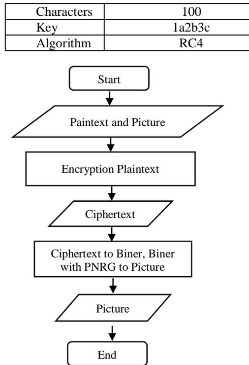
**Gambar 2 Flowchart Proses Enkripsi**
