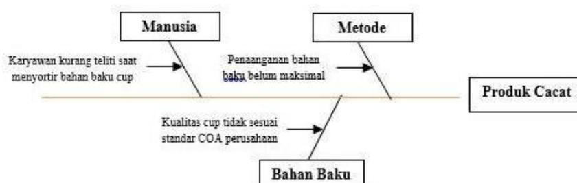
Gambar 9. *Fishbone Diagram Cacat Jenis Cup Tipis*
