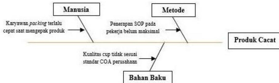
Gambar 8. Fishbone Diagram Cacat Jenis Jatuh Bocor
