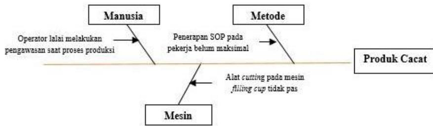
Gambar 2. Fishbone Diagram Cacat Jenis Lid Tidak Terpotong
