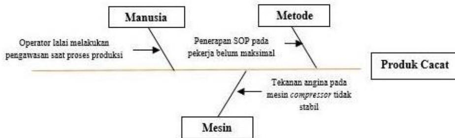
Gambar 6. Fishbone Diagram Cacat Jenis Isi Air Kurang
