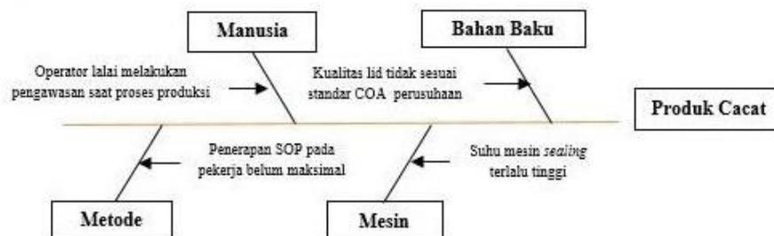
Gambar 7. Fishbone Diagram Cacat Jenis Lid Bocor
