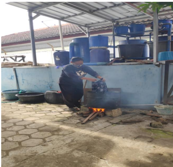
Gambar 3.3. Stasiun Kerja Proses Nglorod Menggunakan Batu Bata (Sebelum Perbaikan )
