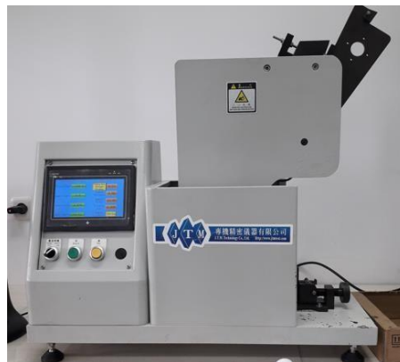
Gambar 5. Mesin Test Izod Impact
