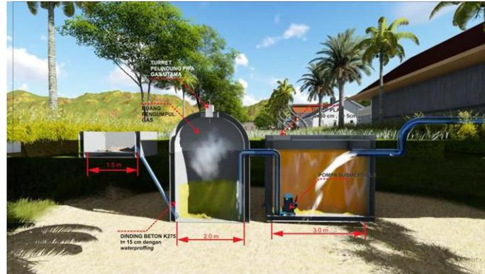
Gambar 6. Ilustrasi Proses Penanganan Limbah Tahu
