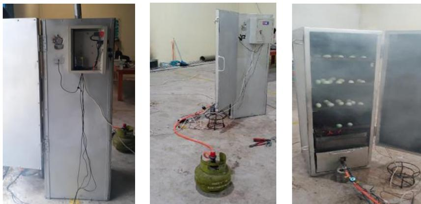
Gambar 2 Proses Pembuatan Lemari Pengasapan dan Pengujian di laboratorium
