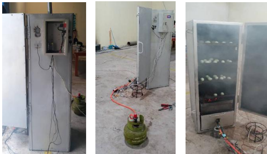
Gambar 2. Proses pembuatan dan uji coba lemari asap terkontrol di laboratorium teknik Universitas Buana Perjuangan Karawang
