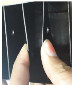
Gambar 2. Pengecekan kekuatan dinding dengan cara ditekan manual
