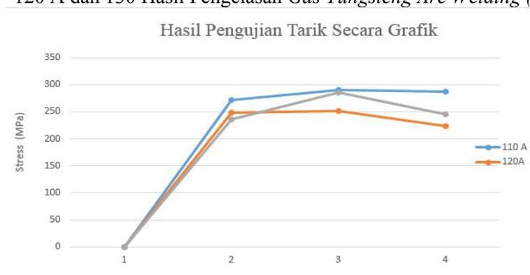
Dari Grafik diperoleh kekuatan tarik maksimal pada masing –masing spesimen sesuai penerapan arusnya, yaitu 110 A, 120 A dan 130 A berturut – turut adalah 289.45 N/mm<sup>2</sup>, 250.82 N/mm<sup>2</sup> dan 285.33 N/mm<sup>2</sup>. Dari data tersebut nilai kuat tarik maksimal tertinggi ada pada spesimen 110 A dibandingkan dengan spesimen arus 120 A dan 130 A.
