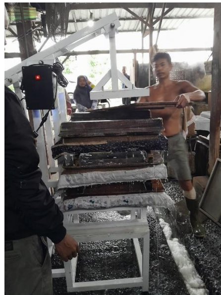
Gambar 2. Delivery penerapan alat press tahu elektrik ergonomi
