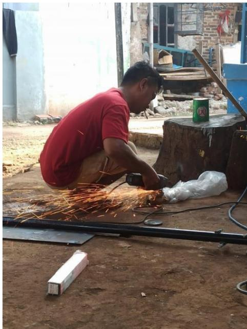
Gambar 1. Pekerja Melakukan Pengelasan tanpa APD
