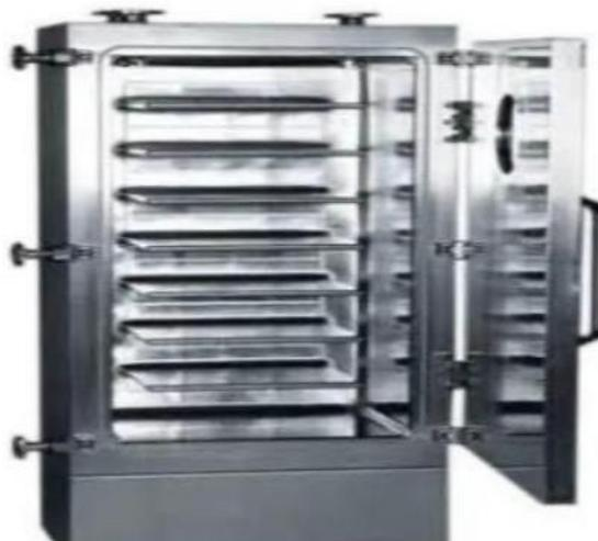
**Gambar 7.** Mesin *tray dryer* pengeringan pare
