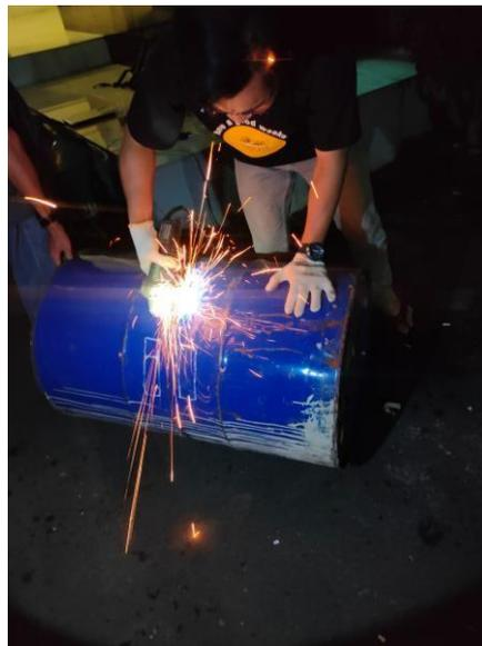
Gambar 4 Proses Pemotongan Drum
