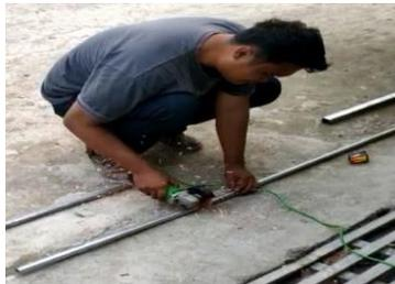
**Gambar 8.** Pemotongan pipa besi
