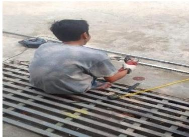
**Gambar 7.** Pemotongan pipa holo.
