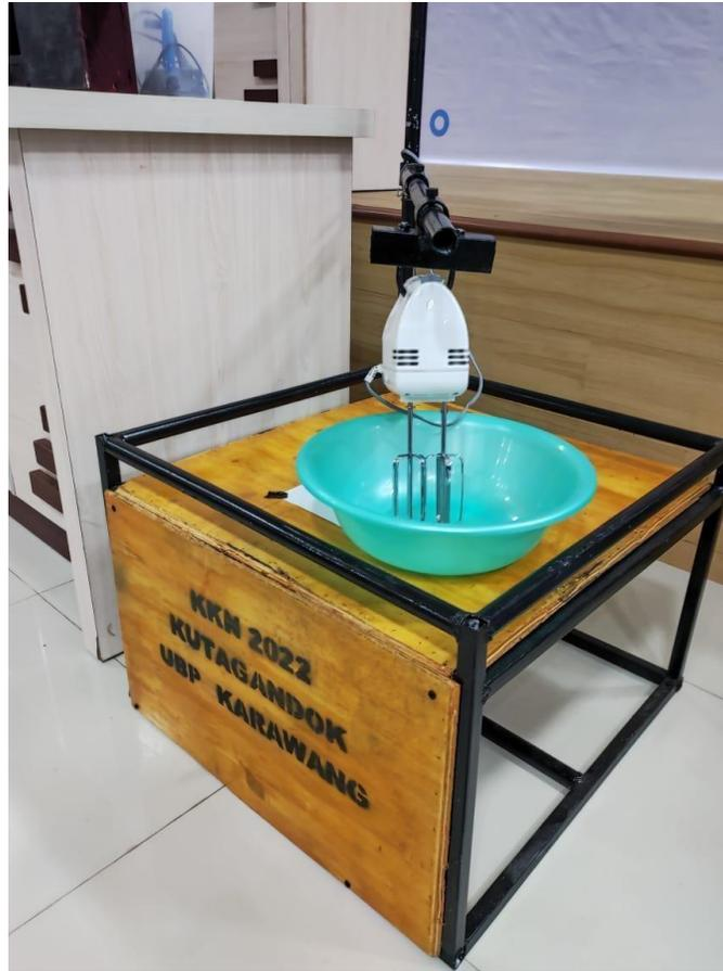
Gambar 3. Hasil Perancangan Untuk Proses Pengadukan Adonan
