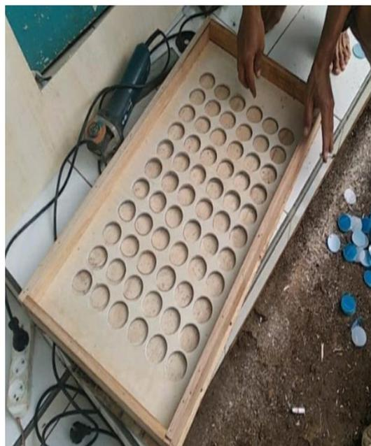
Gambar 4. Gambar alat produksi pembuatan Opak Ketan Bakar.
