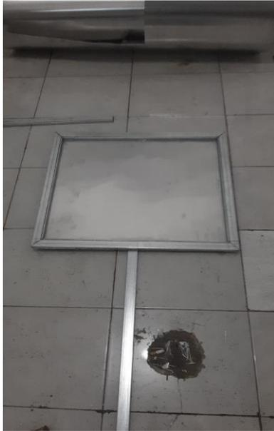
Gambar 2. Pembuatan frame besi
