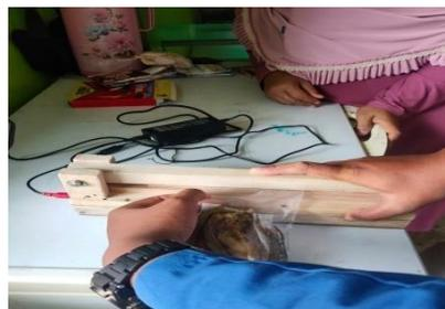
**Gambar 2.** Uji Coba alat *hand sealer* tahap 1
